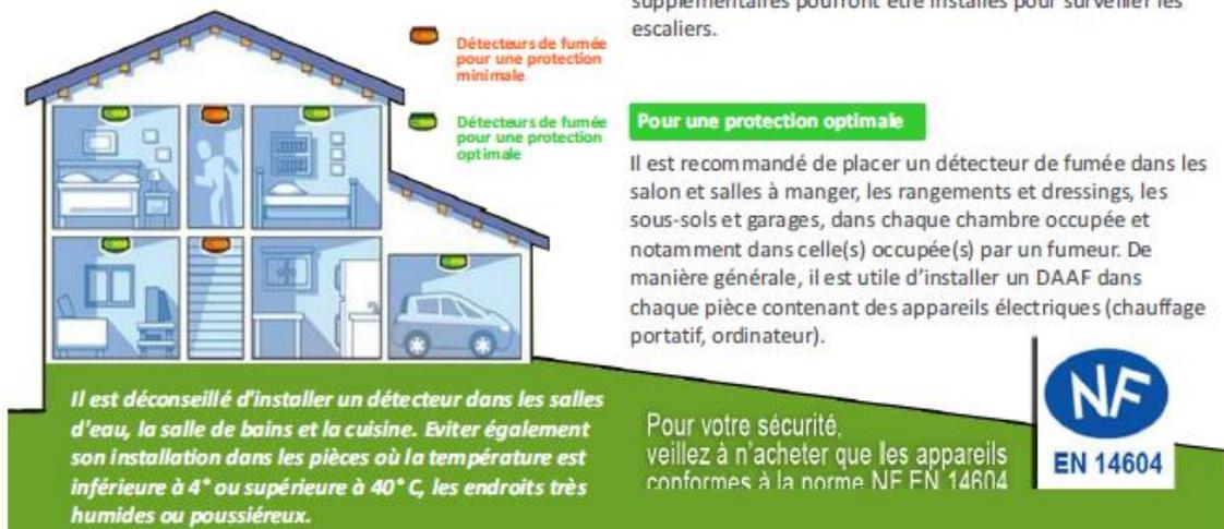
Le meilleur emplacement pour un détecteur de fumée se situe au plafond, dans l'idéal au milieu de la pièce, à défaut, il sera installé à 30 cm des angles de murs et cloisons, des poutres ou autres obstacles. En cas de montage mural, il est conseillé d'installer le détecteur entre 15 cm et 30 cm du plafond. Si le plafond est incliné ou les murs mansardés, l'installation se fera à environ 1 mètre du sommet du mur ou du plafond.
